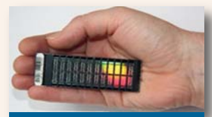
Exemple : puce Bovine SNP 50 permettant l'analyse de 24 animaux. Une zone est composée de micro-billes permettant de lire 54 000 marqueurs sélectionnés.
